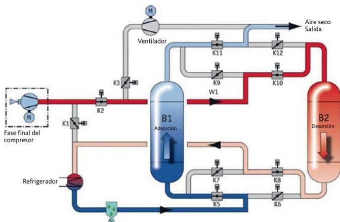
La humedad recogida por el medio de adsorción se evapora y se dirige, con la corriente de aire comprimido, al refrigerador a través de la llave **K8**. Aquí, el aire comprimido se refrigera hasta la temperatura de entrada necesaria para la adsorción. El condensado generado durante la refrigeración se elimina mediante el separador del sistema de aire comprimido.
