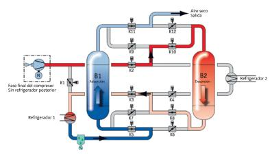
El proceso completo se realiza, tanto en la fase de adsorción como en la de desorción y refrigeración, bajo presión de servicio. Con ello, con el aire comprimido sin aceite, el calor generado en la compresión se aprovecha para la desorción.
