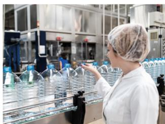
**En empaquetadoras:** En máquinas de empaquetado el aire comprimido entra directamente en contacto con el alimento. Se aplica la clasificación de la calidad del aire comprimido 2:2:1 conforme a ISO 8573-1:2010
